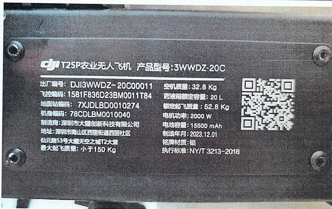
3WWDZ-20C 型 T25P 农业无人飞机——铭牌照片
